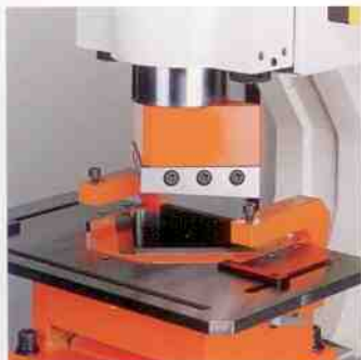
*Large vee-notcher. (punch side)
